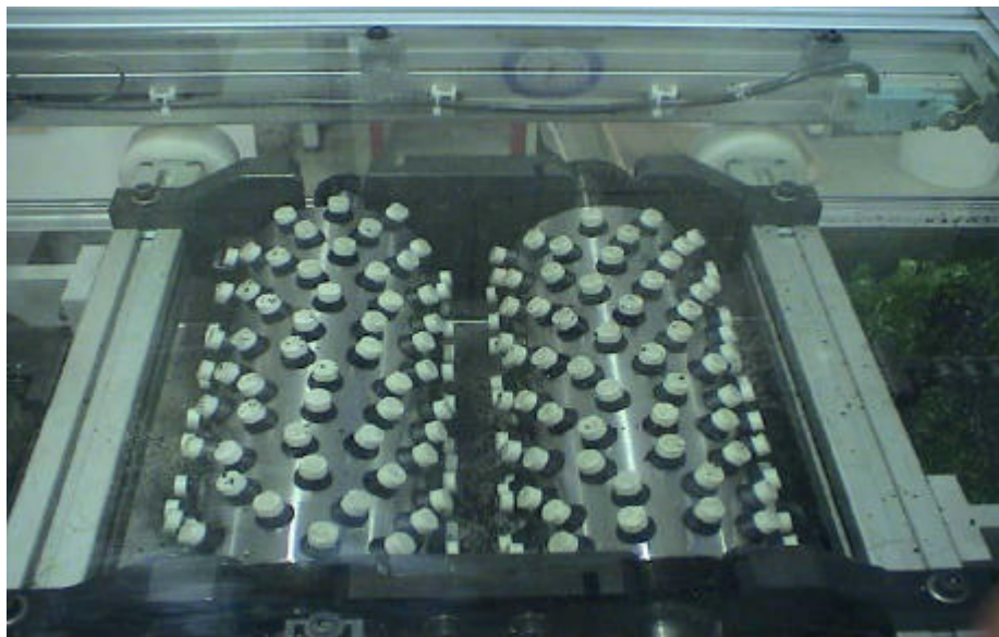
Figura 1 - Posizionamento dei tacchetti da calcio sul rullo di condizionamento e la “Lisport Wear Machine” (dimensioni in mm)
